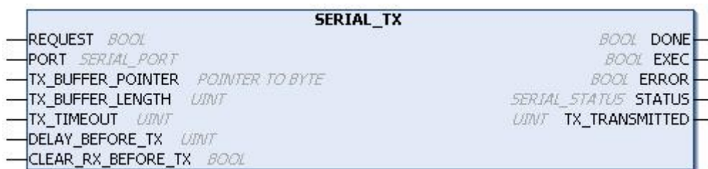
Figura 139: Bloco para Transmitir Valores pela SERIAL_TX
