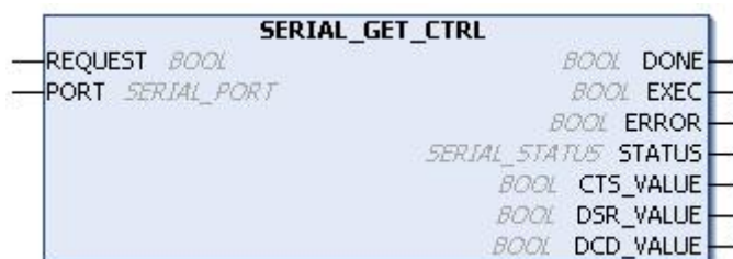
Figura 133: Bloco para Visualizar os Sinais de Controle
