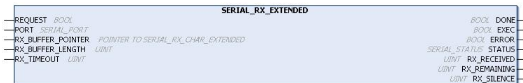
Figura 137: Bloco para Leitura do Buffer de Recepção
