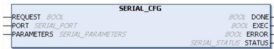
Figura 131: Bloco de Configuração da Serial
