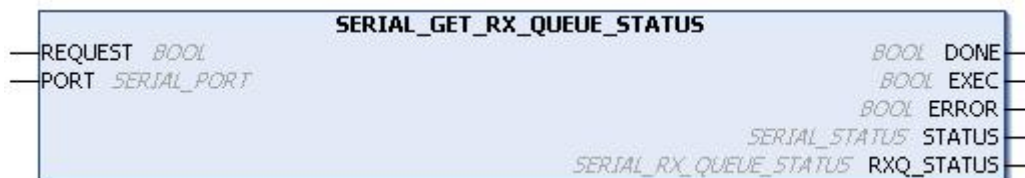
Figura 134: Bloco para Visualizar o Status da Fila RX
