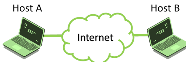
Figura 200: Exemplo de arquitetura Host-to-Host
