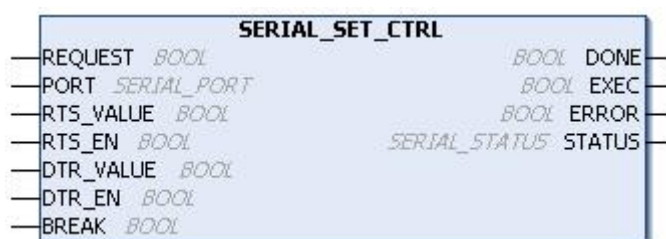
Figura 172: Bloco para Escrever nos Sinais de Controle
